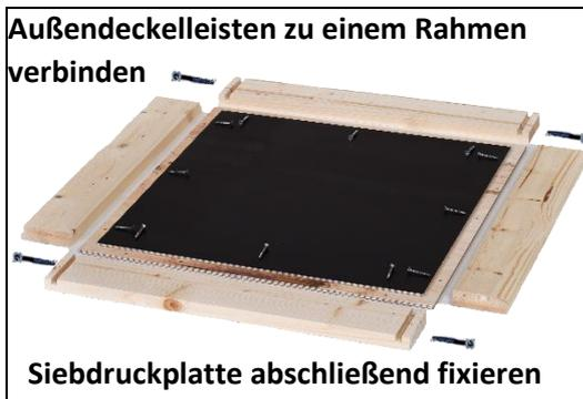
**Die 4 Deckelleisten** wie abgebildet zu einem Rahmen **platzieren** und dabei an **jeder Ecke Nut und Feder gegenüber legen** und mit je **1 Schraube 4 \* 50 mm verschrauben** und ggf. zusätzlich mit **Holzleim präparieren**.
